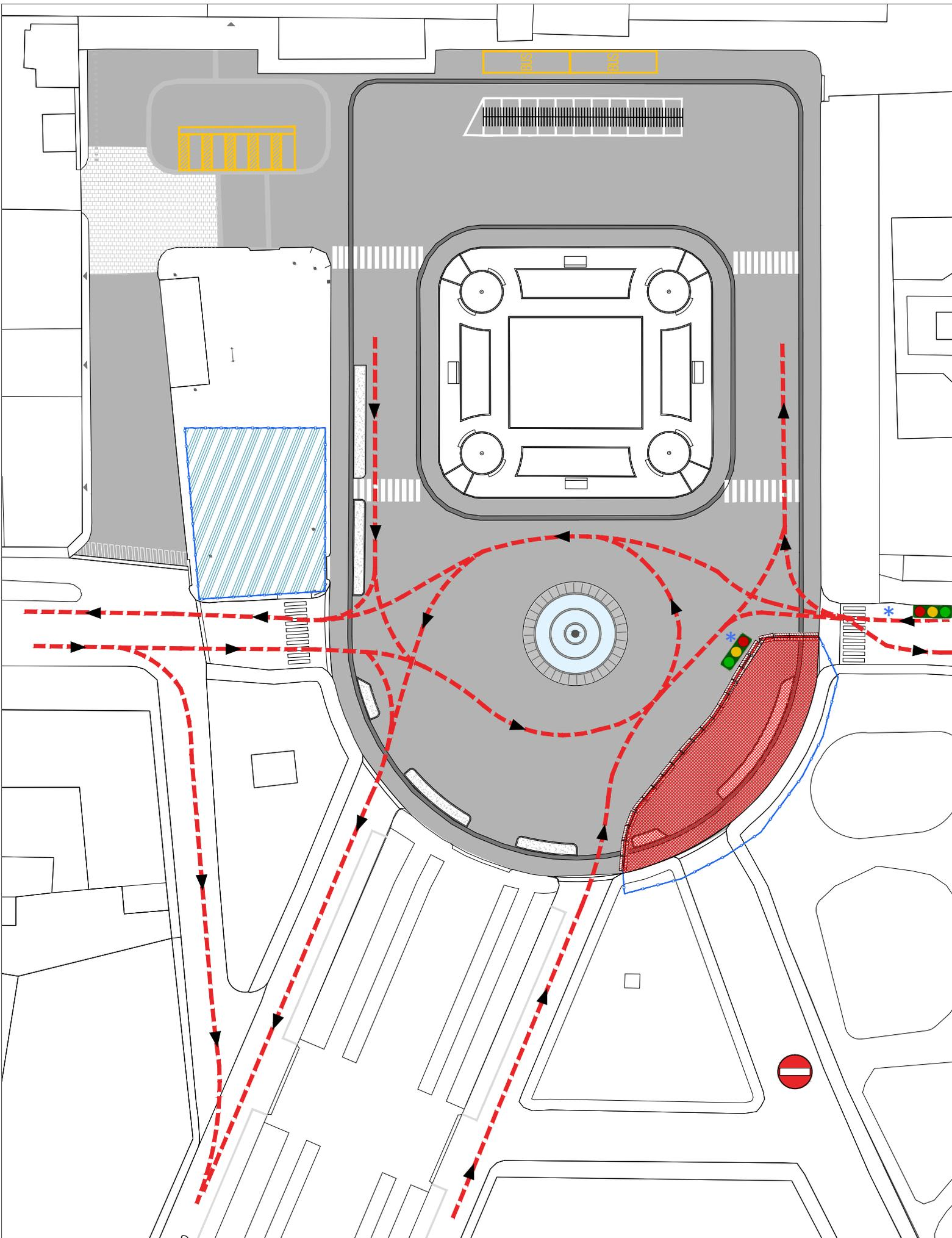
FASE 3: ESECUZIONE DELLE LAVORAZIONI(REALIZZAZIONE NUOVA PAVIMENTAZIONE) - DURATA STIMATA DEI LAVORI 20 gg. (\* DOPIO SENSO ALTERNATO CON REGOLAZIONE SEMAFORICA)
